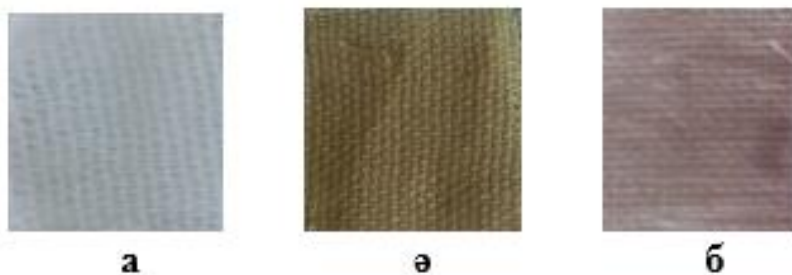
4-сурет. Мысты химиялық қаптаудың жеке кезеңдерінде мата үлгілерінің сыртқы түрінің өзгерісі: а - бастапқы үлгі; я - каталитикалық белсенді мыс бөлшектерін тұндырғаннан кейінгі үлгі; б - мысты химиялық тұндырғаннан кейінгі үлгі.
