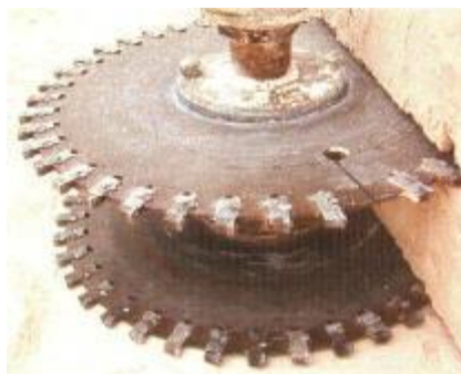
Рис. 3. Дисковая пила камнерезной машины «Прима» Fig. 3. Circular saw blade of the stone-cutting machine «Prima»
