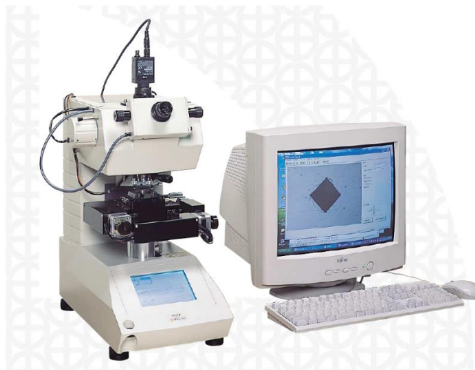
Рис. 6. Микротвердомер Shimadzu HMV-2
