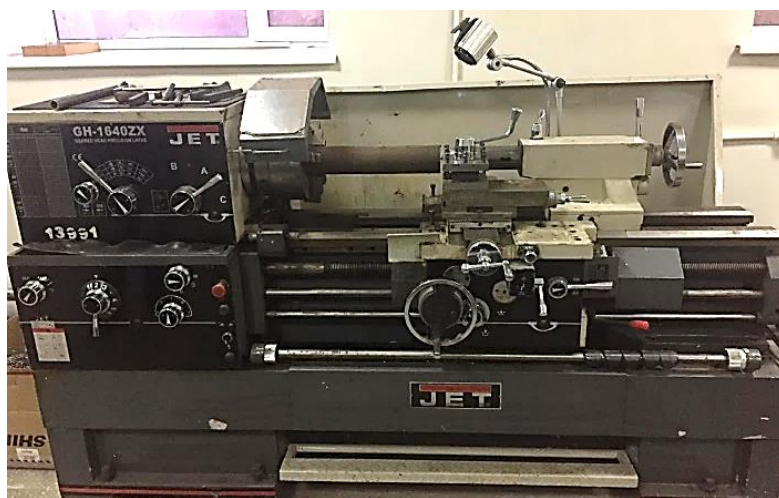
Рис. 3. Токарно-винторезный станок модели JET GH-1640ZX
